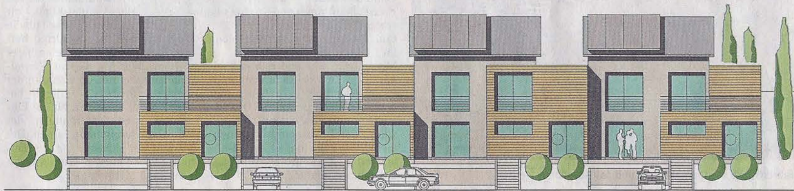
Blick von Süden auf das Vierer-Ensemble im Sobernheimer Baugebiet Leinenborn II. Markant die „Boxen“ zwischen den einzelnen Häusern. Sie sollen den Schall absorbieren, der in den Wohnbereichen entsteht und bei Reihenhäusern üblicherweise hinüber in die Nachbargebäude dringt. Plan: Jacobi & Wolffs
